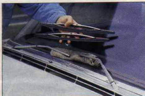
Die Wischblätter leiden unter einseitiger Belastung: entweder ausbauen oder abklappen.
