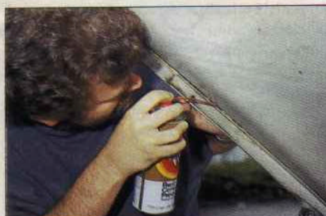
Haubenkanten, Türfalze und Hohlräume werden ebenfalls mit dem Lanolin-Produkt behandelt.
