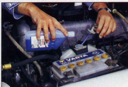
Auch wenn das Auto nicht bewegt wird, kann Frost die Scheibenwaschanlage beschädigen.
