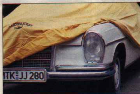
Ein einseitig flanellierter Baumwollstoff schützt den Lack am besten vor Staub.
