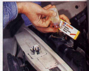
Korrosionsschutz und Kühlerfrostschutz machen sich bei einer längeren Fahrt im Motor vert.
