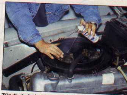
Zündkabel abziehen und starten: Der Motor „atmet“ das Konservierungsmittel ein.
