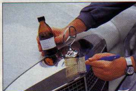
Flüssiges Paraffin aus der Apotheke ist ein idealer Chromschutz — und mit Wasser abwaschbar.
