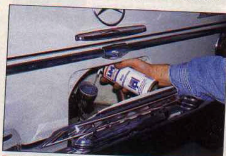
Der verbleibende Hohlraum im Tank wird ebenfalls mit Konservierer behandelt.
