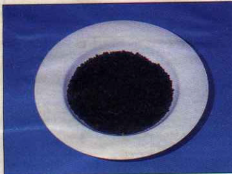
Vorher: Das frische Silica-Gel zeigt mit seiner Blaufärbung an, daß es „durstig“ ist.
