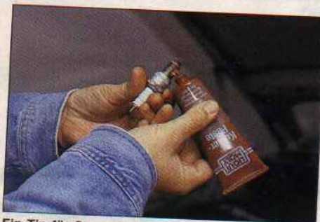
Ein Tip für Sommer und Winter: Kupferpaste verhindert, daß Kerzengewinde festbacken.
