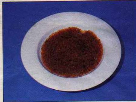
Nachher: Die Rotfärbung bedeutet, daß sich die Kristalle mit Wasser vollgesogen haben.
