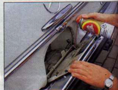
Ein angerostetes Scharnier ist ein Fall für „Film“, es schmiert und stoppt den Rost.
