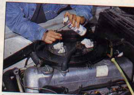
Rachengold: Die Ansaugöffnungen der Vergaser werden mit ölgetränkten Lappen verschlossen.
