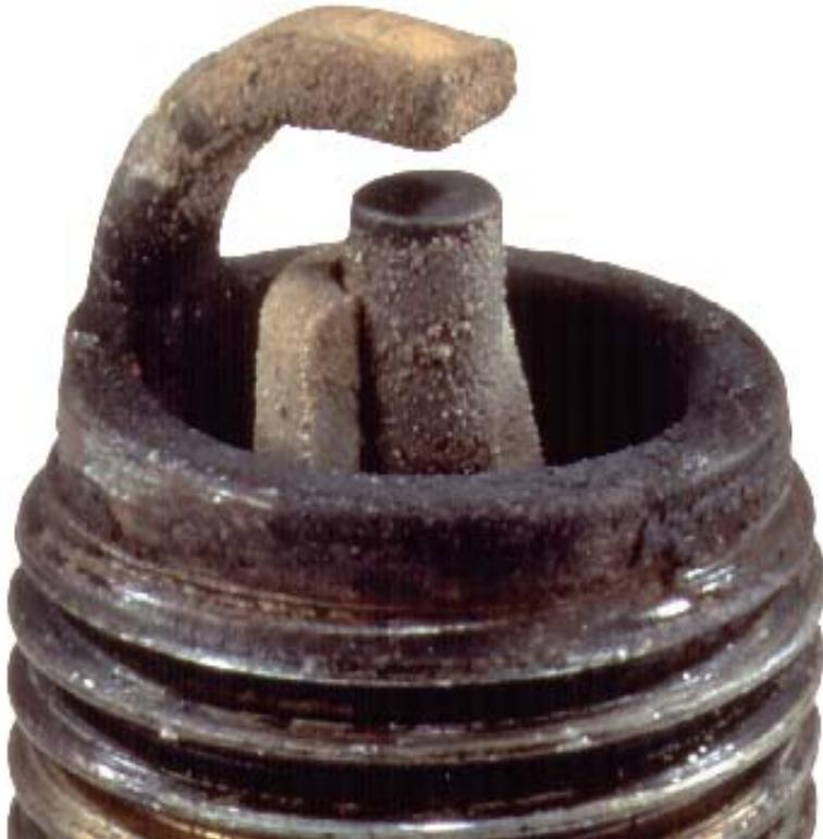
**Keramikbruch durch mechanische Ursache (Montage, Transport, Schlag) oder Thermochock.**
