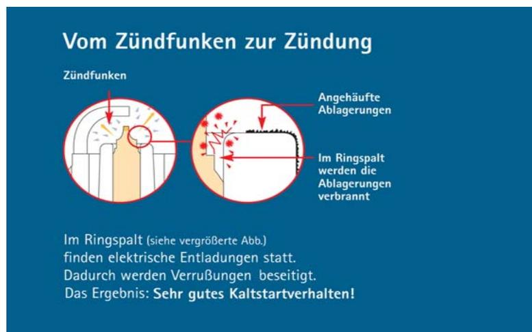
Foto4: **Vom Zündfunken zur Zündung:** Im Ringspalt finden elektrische Entladungen statt. Dadurch werden Verruungen beseitigt. Das Ergebnis ist ein sehr gutes Kaltstartverhalten.
