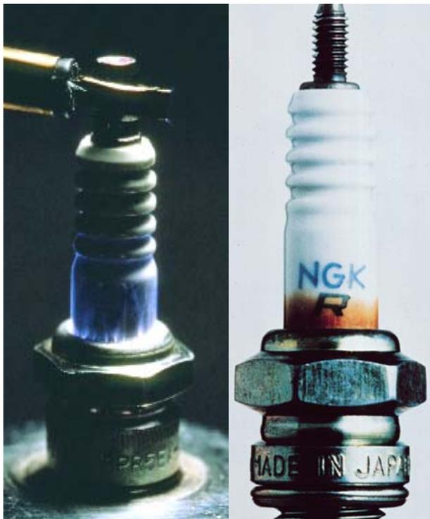
**Normale braune Verfärbung durch Anlagerung elektrisch geladener Ölpartikel. Kein Zeichen von Fehlfunktion oder Undichtigkeit.**
