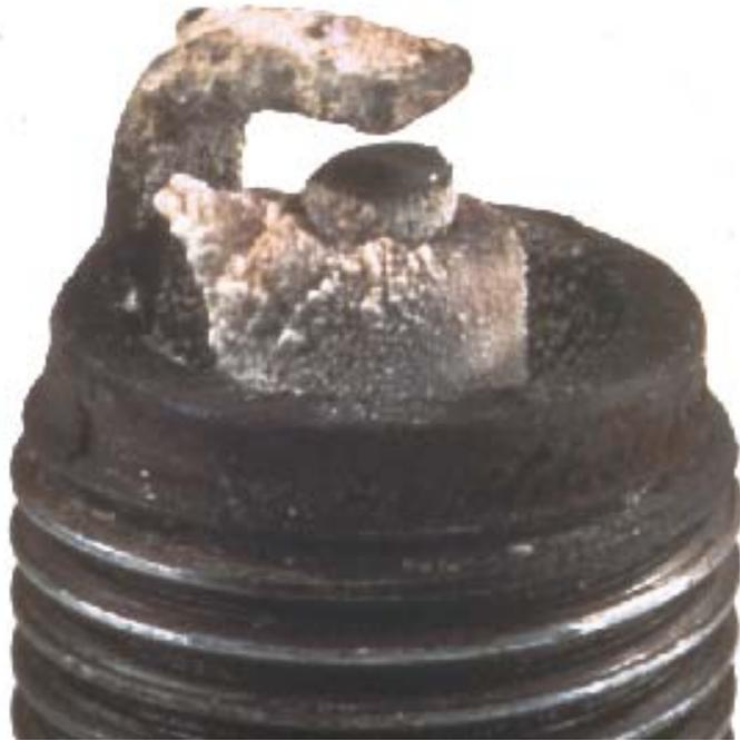
**Ablagerungen bei mechanisch verschlissenen Motoren lagern sich an der Zündkerze an und begünstigen Glühzündungen.**
